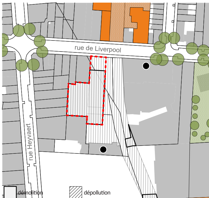
- schéma de dépollution et démolition -
