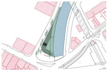
Comparé au Quai de Biestebroek, le Quai Fernand Demets demande un aménagement plus intime et simple. C'est un espace de transition entre les nouveaux développements et le pont Cureghem. L'hauteur de l'abaissement dépend de la position des impétrants et du rejet vers le canal (tracé indiqué en bleu). Une optimisation de la piste cyclable RER peut également profiter de cet abaissement. Une cohérence devrait être recherchée avec l'abaissement potentiel au sud du pont (voir page suivante).
