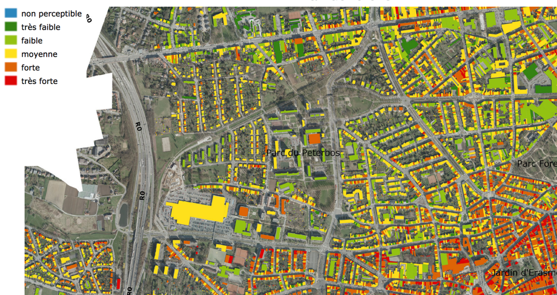
Thermographie aérienne par Bruxelles Environnement en 2008 |
